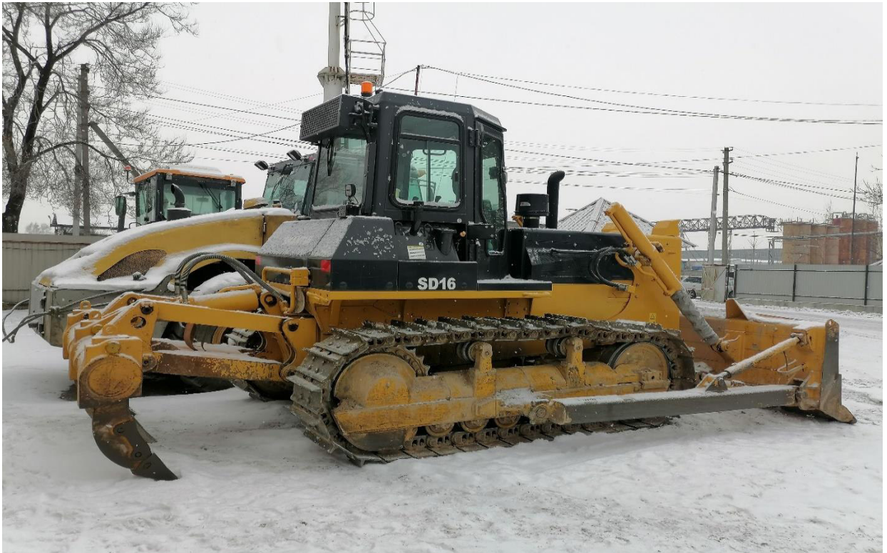
Бульдозер гусеничный SHANTUI SD16 (Управление механизации)
