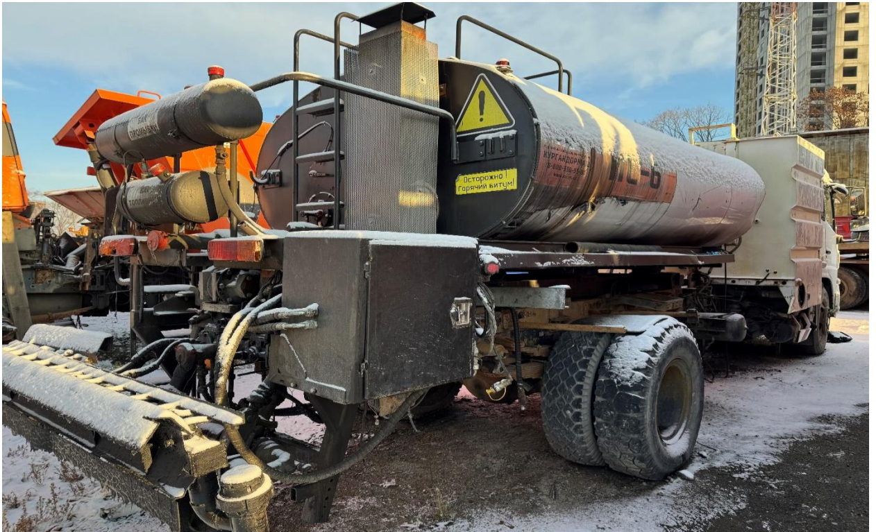
Съемное оборудование (гудронатор) цистерна с объемом 6 куб.м в кузов автосамосвала ИС-6М (филиал «Надеждинский»)
