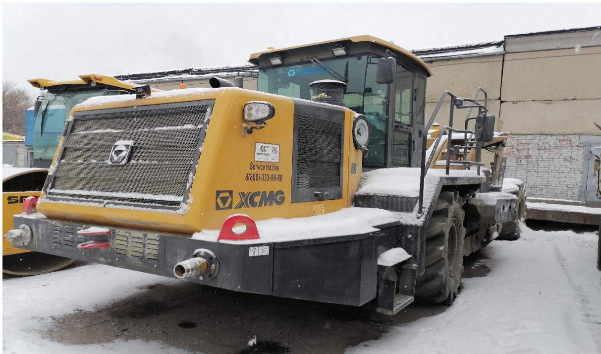
Ресайклер дорожный XCMG XLZ2303S (Управление механизации)
