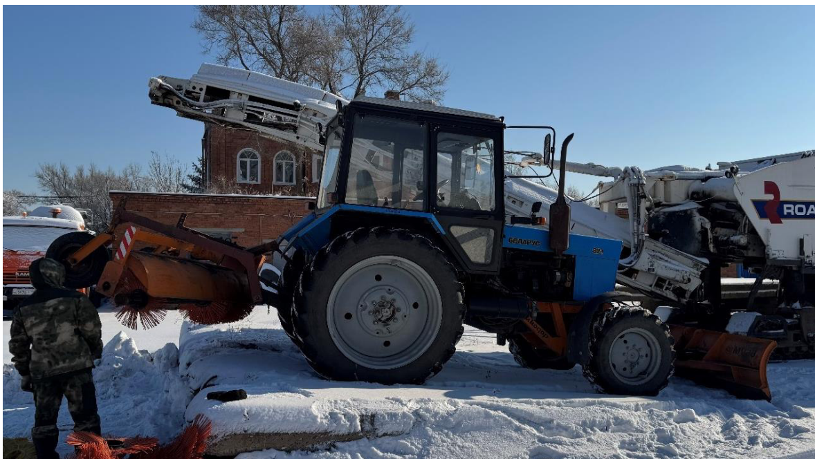
Машина подметально-уборочная АМКОДОР MV20 (филиал «Никольский»)
