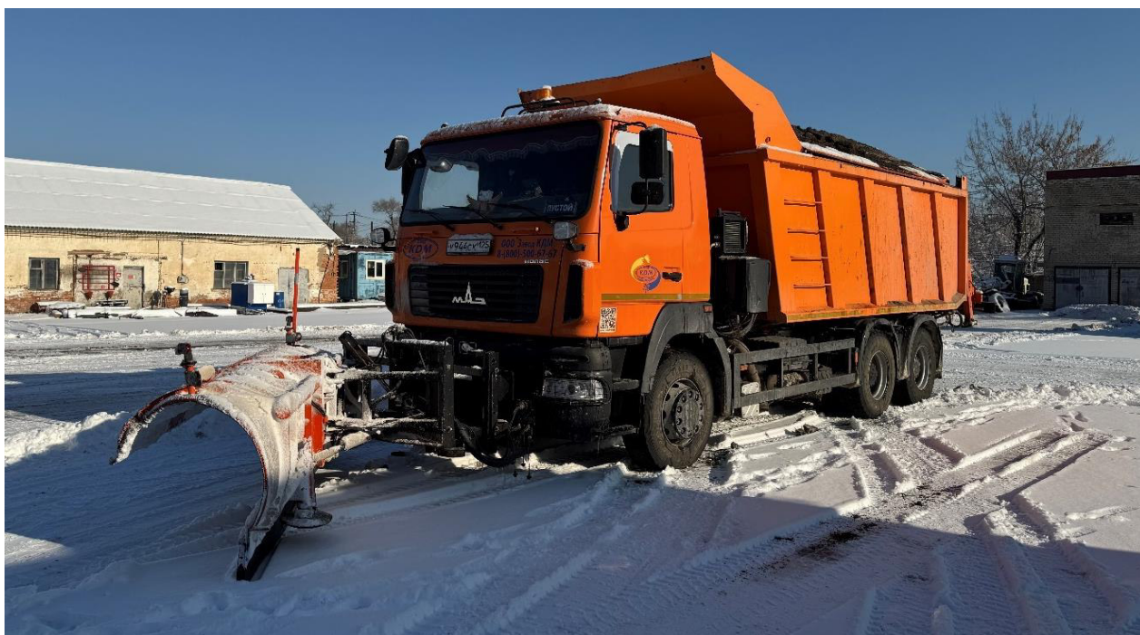
Комбинированная дорожная машина с распределителем твердых реагентов и передним отвалом на шасси автосамосвала с г/п 20 т ЭД244А1-04 на шасси МАЗ 6501С9-520-000 (филиал «Никольский»)
