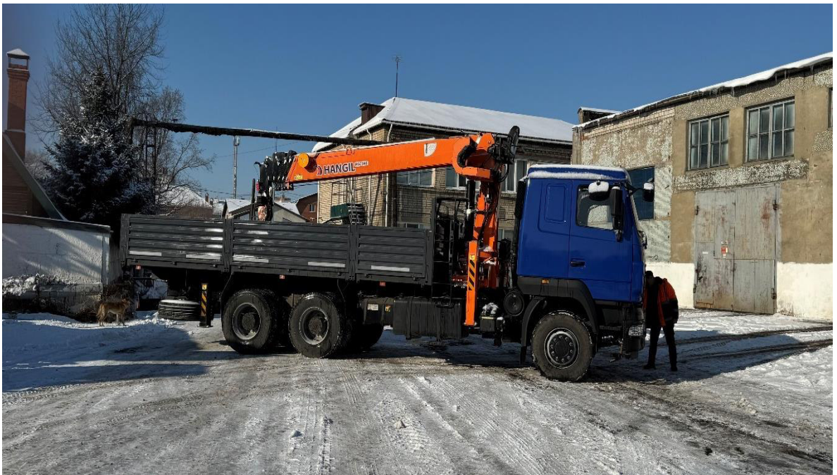
Бортовой автомобиль с КМУ на шасси автомобиля с колесной формулой 6x4 МАЗ-6312С5-8575-012 (филиал «Никольский»)
