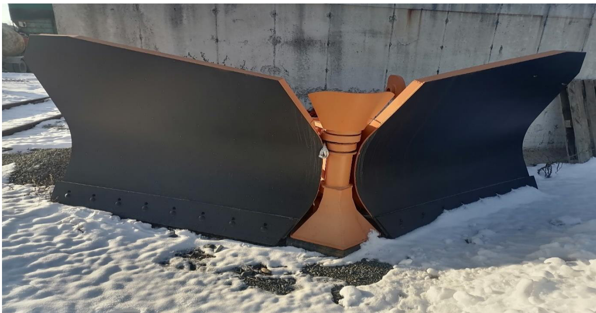
Отвал V-образный для снега 352С.45.55.000 (подразделение – администрация)
