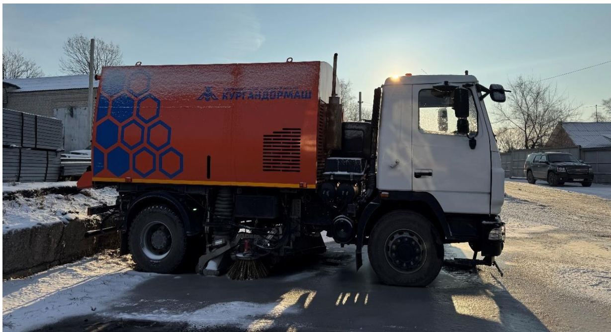
Вакуумная подметально-уборочная машина на шасси автомобиля с колесной формулой 4x2 КО-5340 на шасси МАЗ-5340С5-8575-013 (филиал «Надеждинский»)
