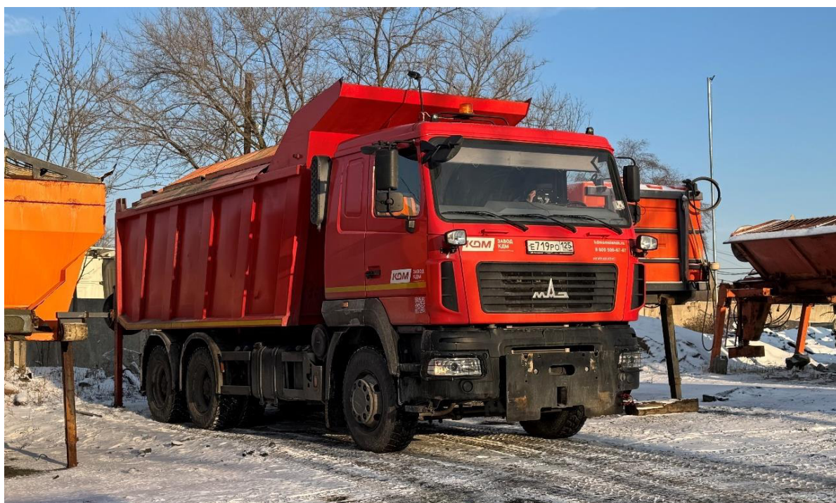
Комбинированная дорожная машина на шасси с колесной формулой 6x4 и объемом кузова 20 куб.м ЭД-244А1-02 на шасси МАЗ-650128-570-000 (филиал «Надеждинский»)
