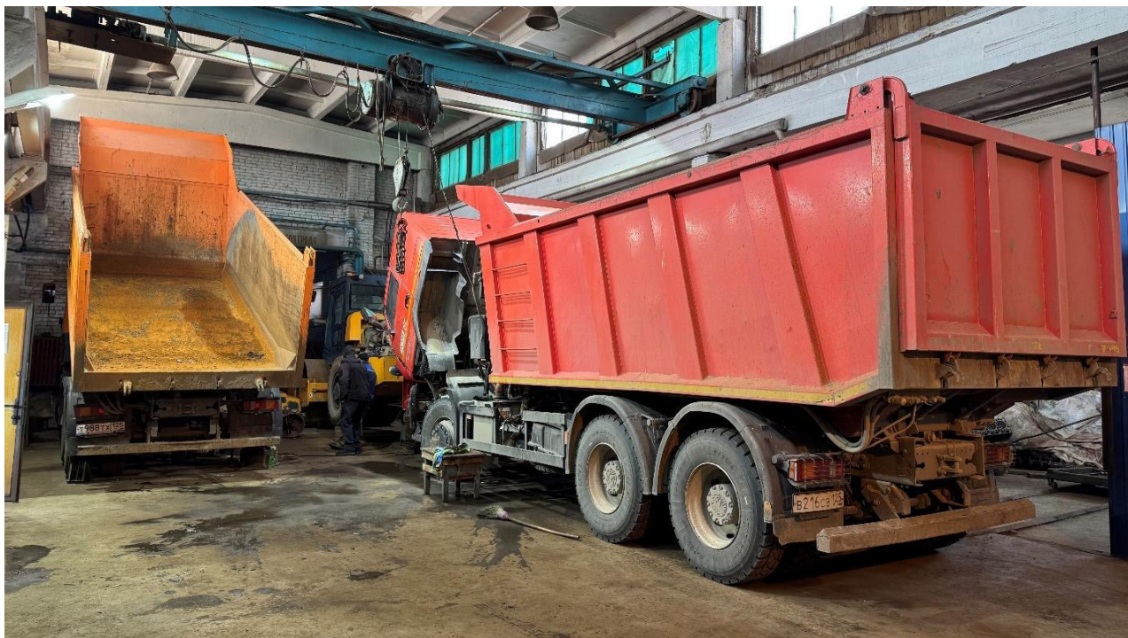
Комбинированная дорожная машина с распределителем твердых реагентов и передним отвалом на шасси автосамосвала с г/п 20 т ЭД244А1-04 на шасси МАЗ 6501С9-520-000 (филиал «Никольский») – на техническом обслуживании
